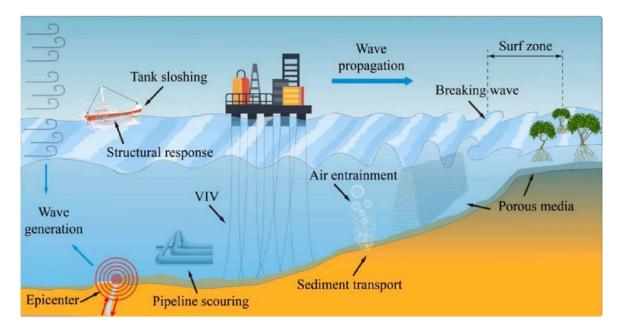
Ilustrasi proses terjadinya pergerakan gelombang dan arus di kawasan pesisir pantai (sumber: jurnal penelitian Min Luo dkk)
